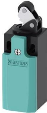
Positionsschalter mit erhöhtem Korrosionsschutz Kunststoffgehäuse nach DIN EN 50047, 31 mm Geräteanschluss 1 x (M20 x 1,5) 1S/1Ö Sprungkontakte (austauschbar) Rollenhebel aus Edelstahl mit Kunststoffrolle 13 mm
