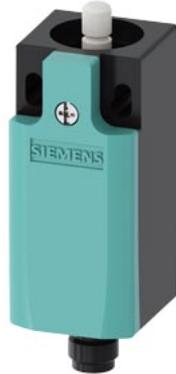
Positionsschalter Kunststoffgehäuse nach DIN EN 50047, 31 mm 1S/1Ö Sprungkontakte integriert (nicht austauschbar) mit M12-Stecker, 4-polig Pin-Belegung: Pin1=21, Pin2=22 Pin3=13, Pin4=14 für maximal 250 V und 4 A, mit Kuppenstößel
