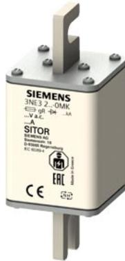
SITOR-Sicherungseinsatz, mit geschlitzten Messerkontakten, NH1, In: 630 A, aR, Un AC: 1000 V, Un DC: 600 V, ohne Kennmelder
