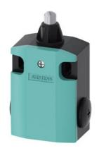
Positionsschalter Metallgehäuse 56 mm breit Geräteanschluss 3 x (M20 x 1,5) 1S/1Ö Sprungkontakte Kuppenstößel, mit 3 mm Überhub aus Edelstahl Betätigungs-/Rückstellkraft 30 N nur als Komplettgerät lieferbar
