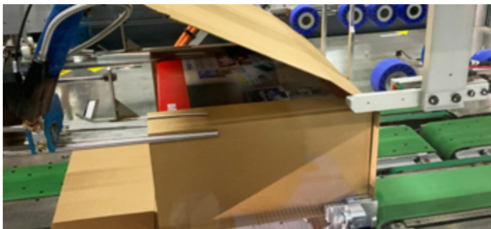
Die Fit2Size-Verpackungsmaschine: Die maßgeschneiderte Verpackung für den Versand sorgt für weniger Füllmaterial.
