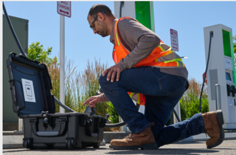
Schnelle Fehlersuche: Mit dem Fluke FEV 500 lassen sich Ladepunkte zuverlässig testen und bewerten.
