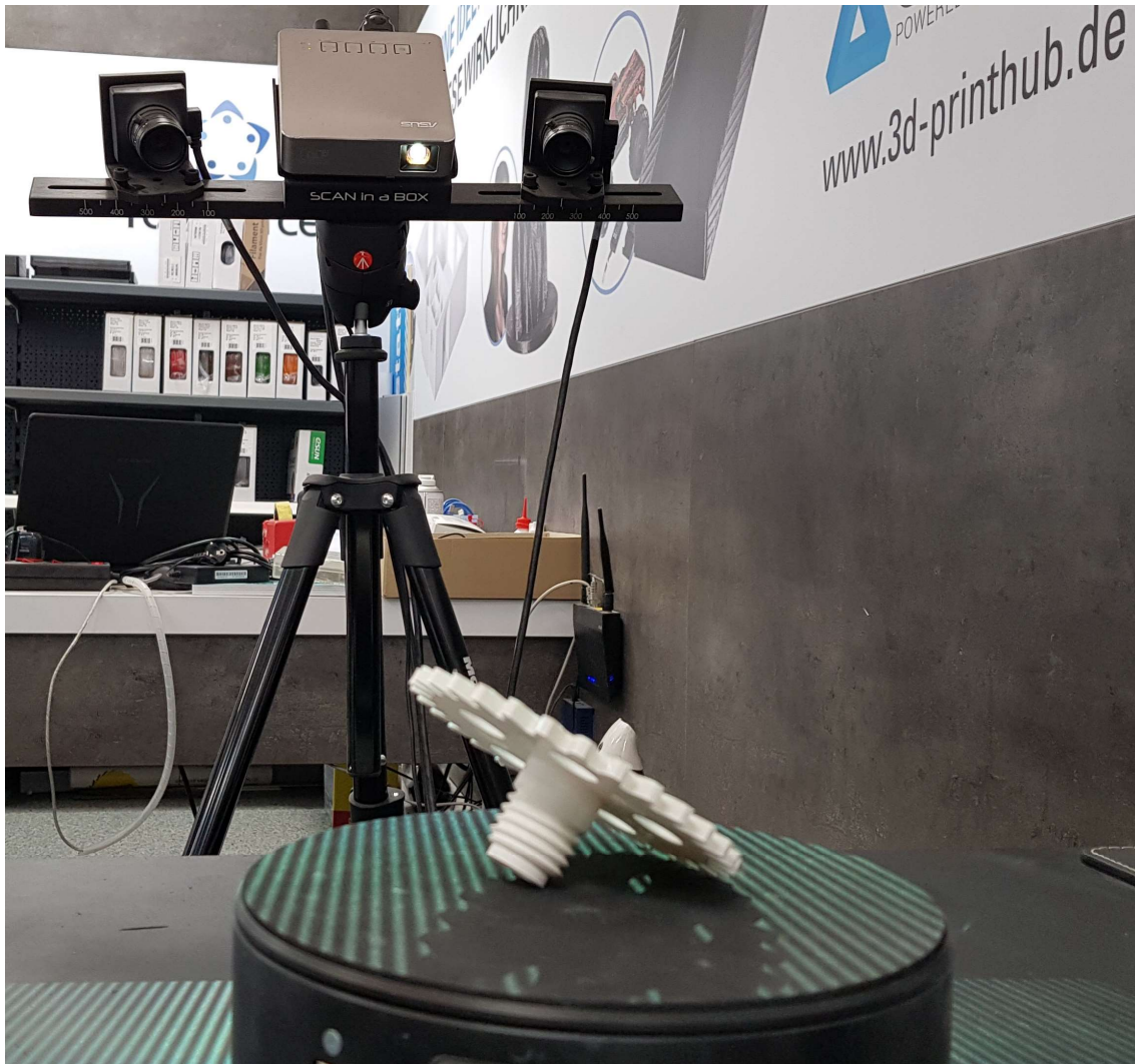
Abbildung 42: 3D-Scan mit strukturiertem Licht – Oberflächenverlauf ergibt Verzerrungen im Linienmuster
