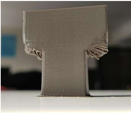
Abbildung 55: Parameter beim Slicing - Folgen des Drucks von Überhängen ohne Stützstruktur
