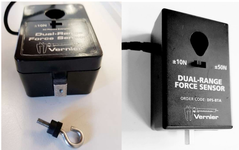
Abbildung 90: Foto des Kraftsensors ohne Haken – 6-Kant der Kraftaufnahme (2 unterschiedliche Bauformen)
