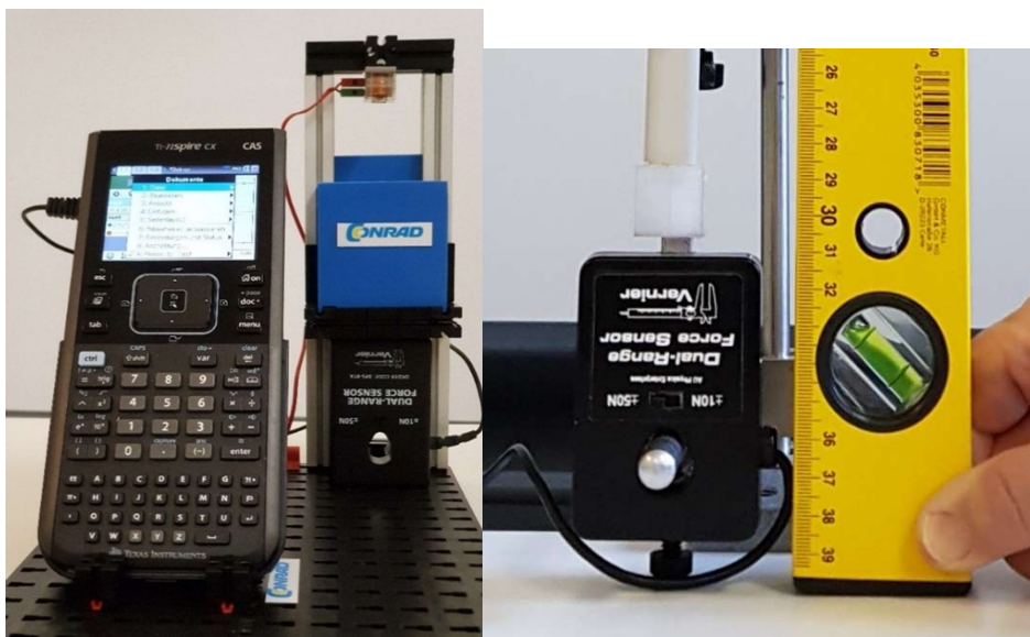
Abbildung 92: Vorschlag zum Versuchsaufbau: a) Konstruktion mit fischertechnik, b) Aufbau mit Stativmaterial
