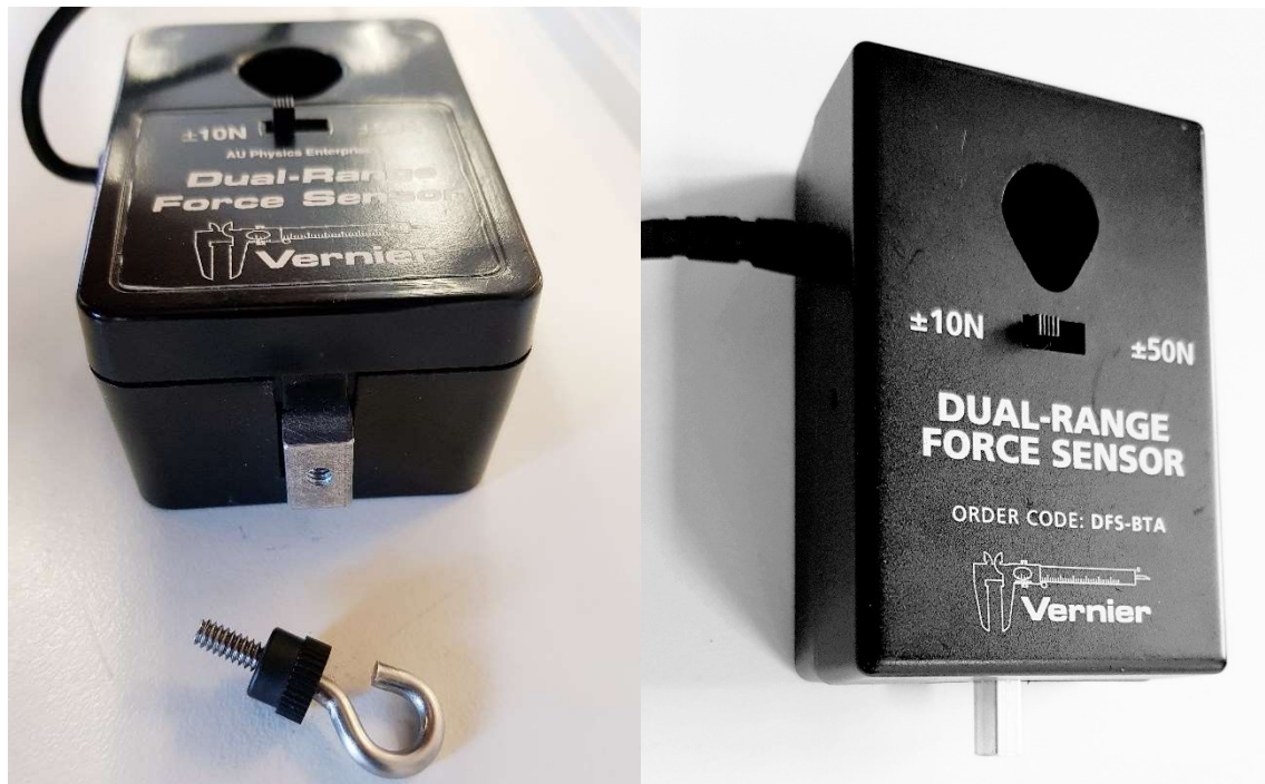
Abbildung 99: Foto des Kraftsensors ohne Haken – 6-Kant der Kraftaufnahme (2 unterschiedliche Bauformen)
