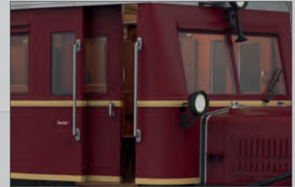
Servomotorisch zu öffnende Türen
