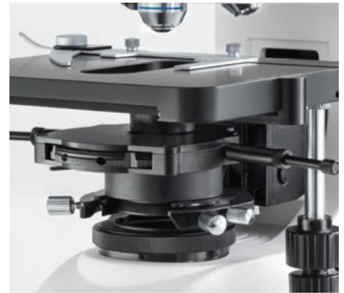
OBN-15 : Condenseur de contraste de phase monté
