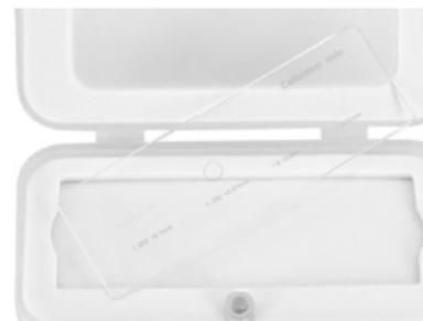
Accessoires : Micromètre à objets, pour l'étalonnage de la fonction de mesure du logiciel, KERN ODC-A2404, € 40,-
