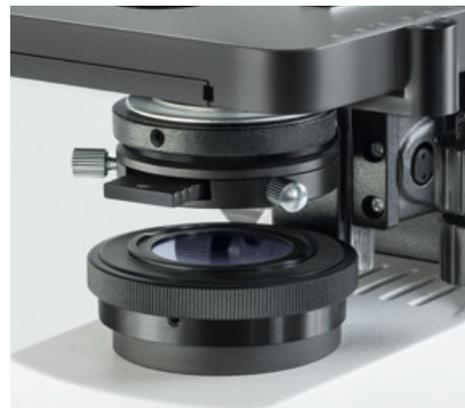
Condenseur de contraste de phase monté
