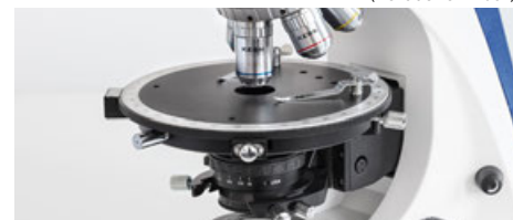
Zentrier- und drehbarer Polarisations-Objekttisch
