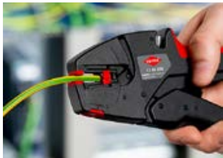
Automatische Anpassung an unterschiedliche Leiterquerschnitte.
