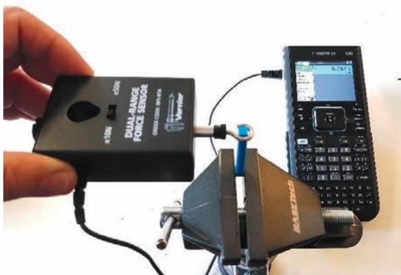
Figure 109 : Le solide est serré dans l'étau - La force appliquée ici est de 6,7 N
