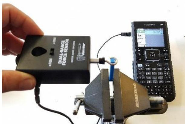
Le capteur doit être remis à zéro avant la mesure (maintenez-le le plus immobile possible ; de petits écarts sont tolérés dans le cas d'expériences pratiques). Dès que la mesure démarre, tirez sur le capteur parallèlement au plateau d'impression jusqu'à ce que le solide en 3D se brise. Répétez l'expérience plusieurs fois avec des solides similaires, pour vérifier les résultats. Répétez ensuite le test avec l'autre sens au moment de l'impression (vertical ou horizontal).
