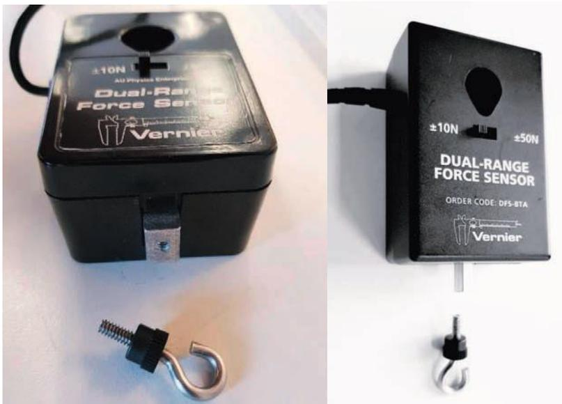
Figure 99 : Capteur de forces sans crochet - Hexagone pour l'enregistrement de la force (2 formes différentes)
