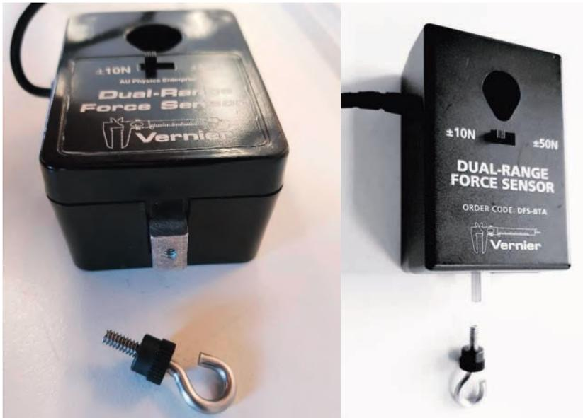
Figure 90 : Capteur de forces sans crochet - Hexagone pour l'enregistrement de la force (2 formes différentes)
