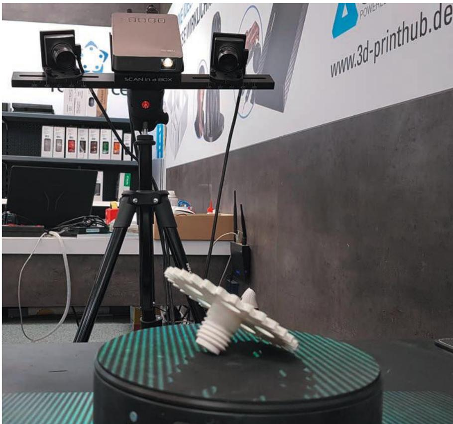
Figure 42 : Scan 3D avec lumière structurée. Le relief de l'objet provoque des déformations des lignes.
