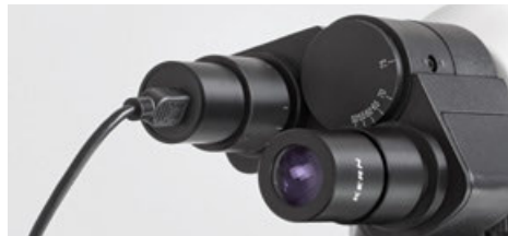
Fotocamera oculare fissata al tubo
