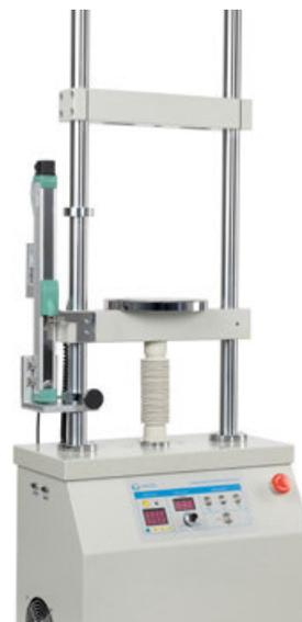
Banc d'essai motorisé incl. appareil de mesure de longueur LD
