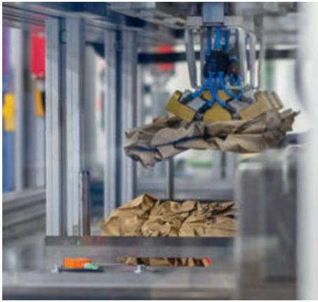
Vollautomatisch: Roboterarme schnappen sich das geknüllte Papier und füllen es ins Paket ein.
