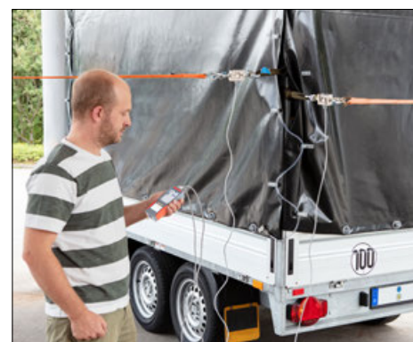
Mesure des forces dans différentes directions de traction ou de compression, possible avec un seul appareil de mesure
