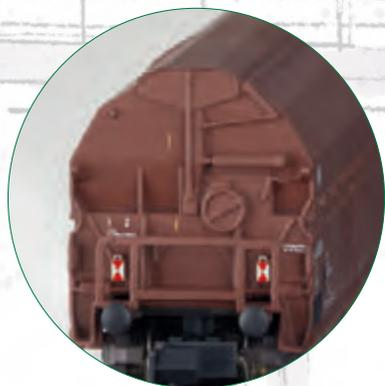
Ein Wagen mit bedruckten Zugschlussscheiben an einem Wagenende
