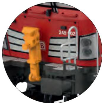
Der Vectron mit zusätzlicher Rangierbühne und Immitation der automatischen Rangierkupplung
