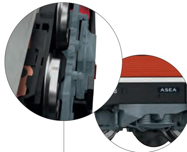
Um die Federn und die Schlingerdämpfer in ihrer 3-Dimensionalität optisch vorbildgerecht darstellen zu können, sind die Drehgestellaufhängungen am Drehgestell aus einem Guss, sodass mehr detaillierte Tiefe des Modells erzielt werden kann.
