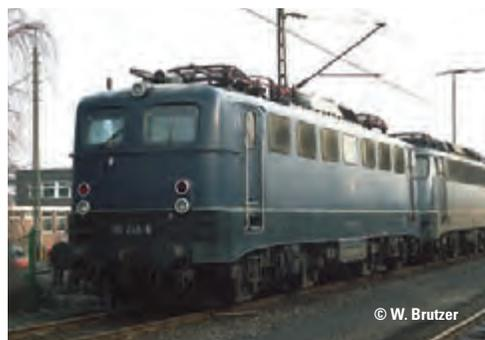
**Vorbild:** Einheits-Elektrolokomotive 110 246-6 der Deutschen Bundesbahn (DB). Kobaltblaue Grundfarbgebung. Ausführung mit Doppellampen, Kunststoffregenrinnen über den Frontfenstern und Führerstandtüren, Doppel-düsenlüftergitter (DDL), ungeteiltes Maschinenraumfenster mit Gummidichtung und stirnseitige Handgriffe. Zustand um 1988.
