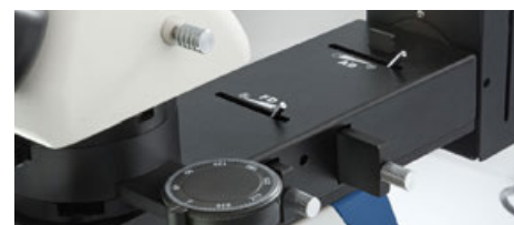
Lente Bertrand, vetrino \lambda , analizzatore girevole a 360° (estraibile)
